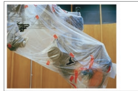
Die bewegliche Scan Platform der Sonde trägt, neben anderen Messgeräten, die Kameras der Voyager ( Narrow and Wide Angle Image Subsystem ). Besides other instruments, the moveable Scan Platform houses the Voyager 's cameras ( Narrow and Wide Angle Image Subsystem ).
