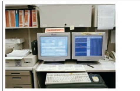
Voyager Mission Controller , Voyager-Steuercomputer. Die hier eingegebenen Daten werden über die Antennen des Deep Space Network ins All zu den beiden Voyagers gesendet. Voyager Mission Controller navigation computer. Data entered here is transmitted to both Voyager probes via the Deep Space Network .
